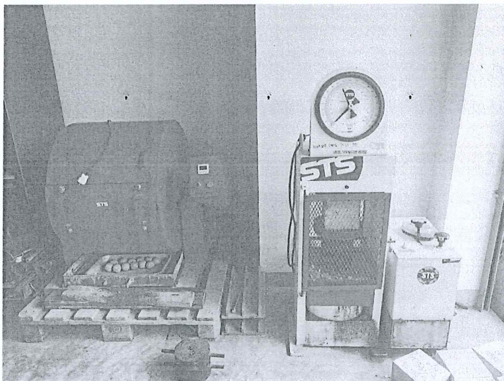
เครื่องมือทดสอบหาค่าความเสีกร้อนของหิน, ทดสอบแรงอัดคอนกรีต
